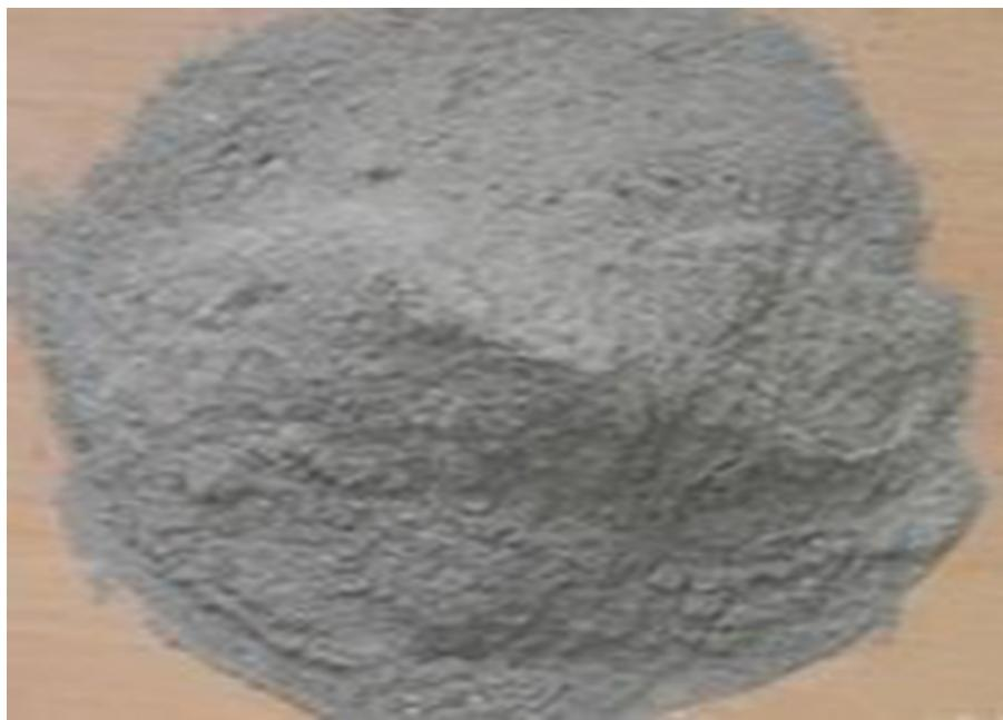
1 、高分子聚合物水泥基预制干拌料。具有优良的粘接性，良好的增强抗下垂性、保水性、抗水性、耐老化性和操作性。施工简便，性污染。
